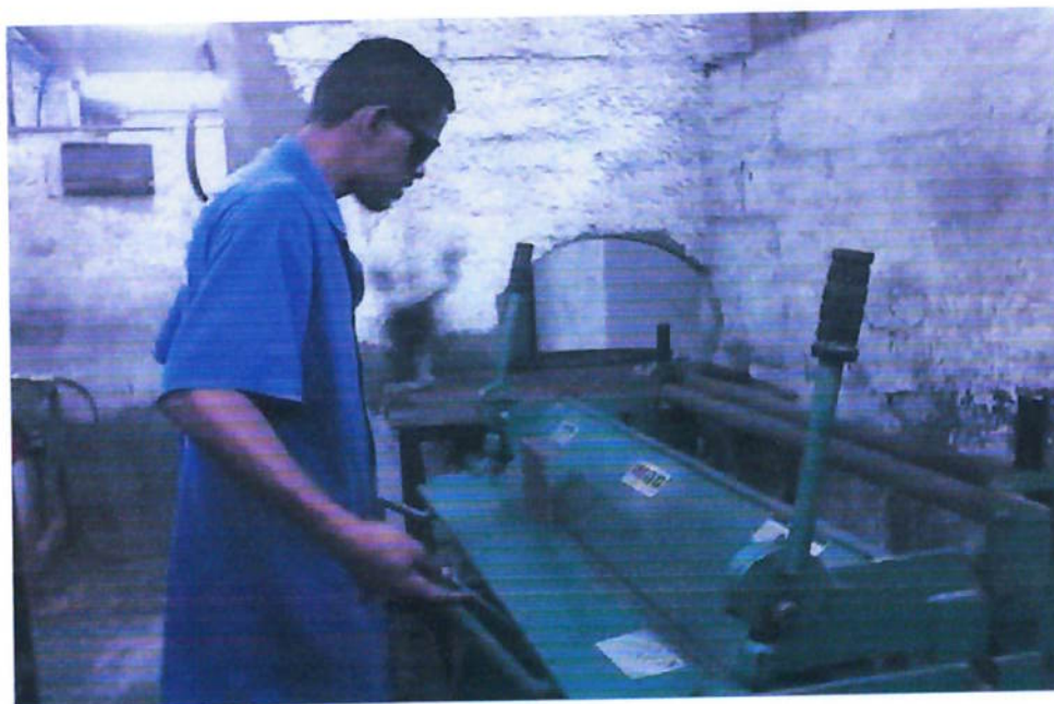
Figura 7 – Operação com máquinas de dobra de chapas (fonte: Abramam)
